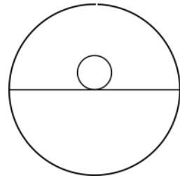
2 - 4 - faire tourner le sextant autour de son axe optique dans un mouvement de balancement pour s'assurer que l'image du bord inférieur du Soleil est, au point le plus bas de sa course, exactement sur la ligne d'horizon.
